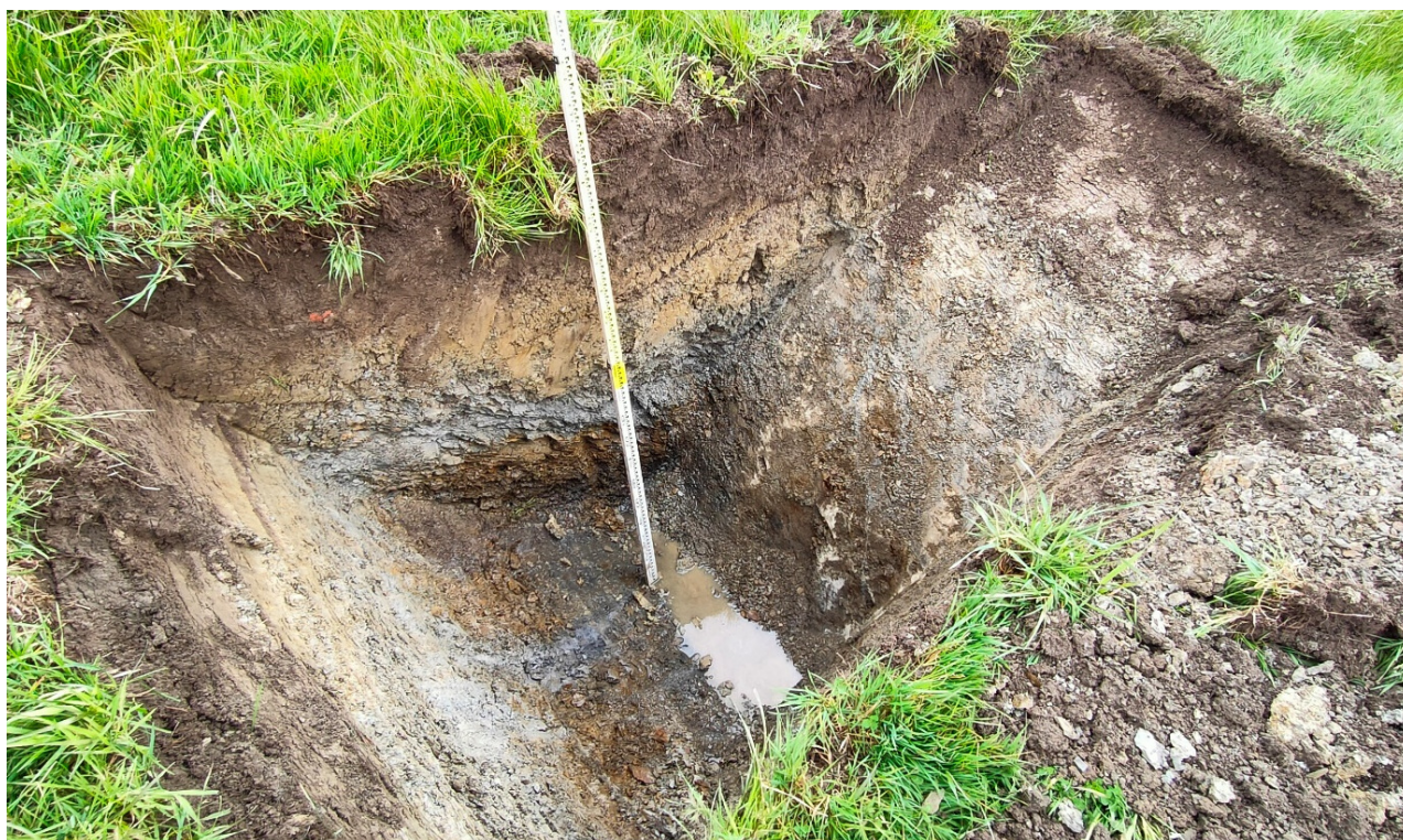
Slika 6: Vpogled v sondažni razkop S2 do globine 1,8 m
