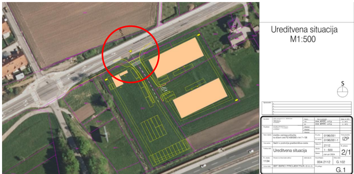
Slika 9: Predlagana inženirska rešitev novega priključka na R2-409 odsek 0300 v km 7+138
